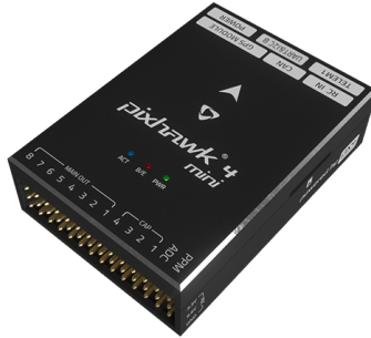
Figure 4.9. Holybro Pixhawk 4 Mini autopilot device.
