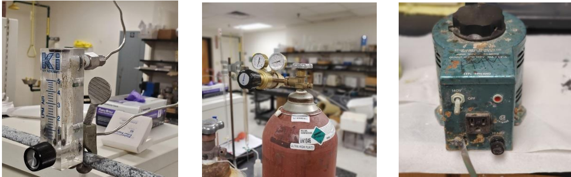
Fig 12 - a) Rotameter b) Helium Gas Tank c) Variac
