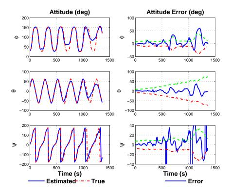
Figure 9.10. BPF Joint Estimation of Attitude (Euler Angles).
