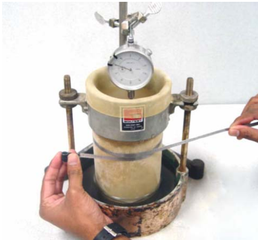
Figure 2.9: Three dimensional free swell test setup (Punthutaecha et al., 2006)
